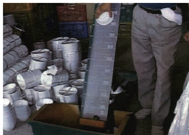
高強度300は、高さ100cmまで耐える。ちなみに、強度230の「Re-高強度磁器食器OGISO」は高さ80cmまで耐える。(試験体は、直径150mm、高さ46mmの深皿)
