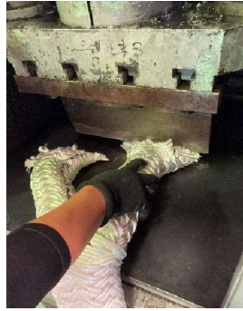
ホーサーを切断する
